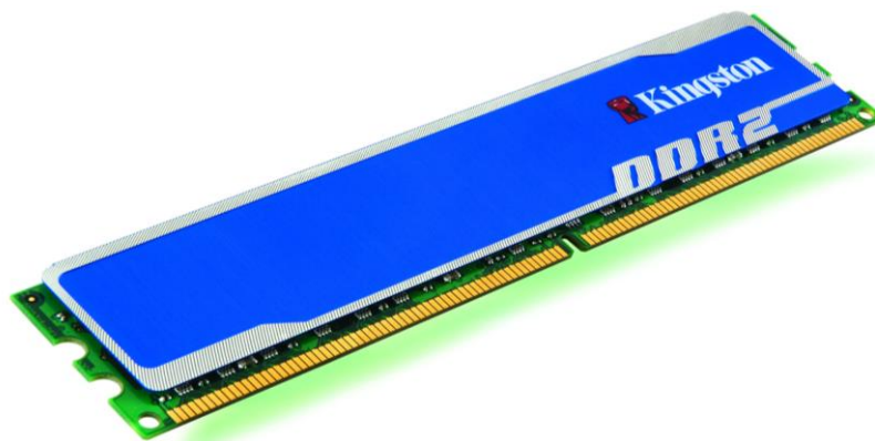
Figura 6 - Módulo DIMM DDRII 240 contatos
